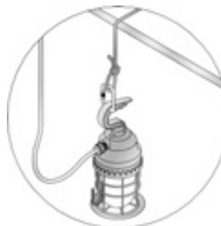
Içamento com corda pelo mosquetão
